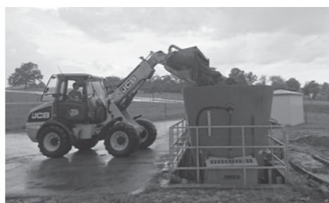
液状の糞尿はポンプで発酵槽に送られる。固形の原料はローダーで決まった量を搬送機へ投入し、定時に発酵槽へ送られる仕組みだ
